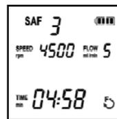
Сброс (обнуление) таймера осуществляется в любое время с помощью нажатия на кнопку «TIMER» на панели управления, автоматически в случае достижения предельного значения времени (99:59 мин), после отключения питания блока управления или после отсоединения наконечника «SAF SYSTEM» от рабочего кабеля.
